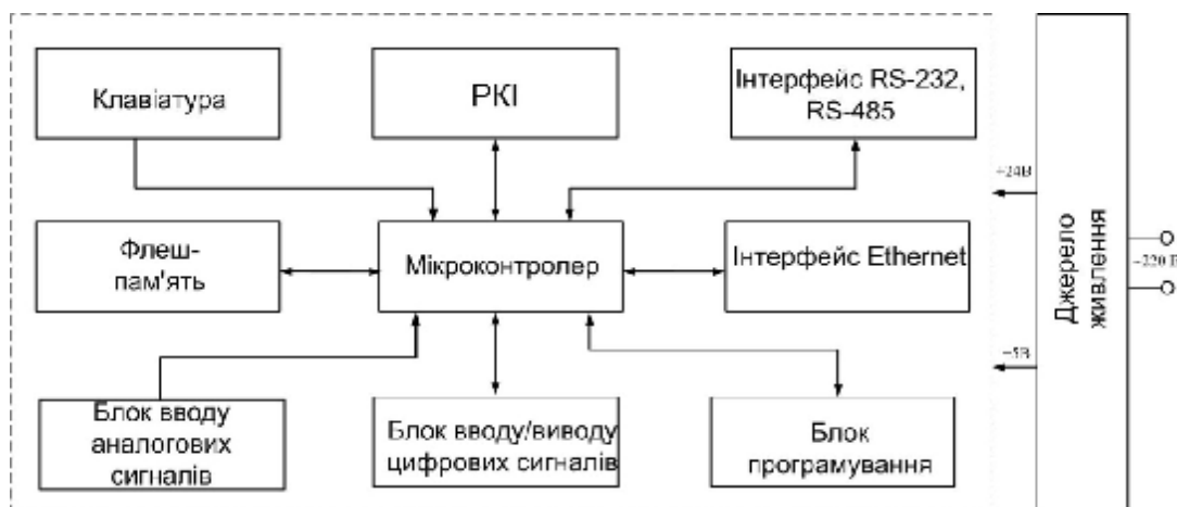
Рисунок 1 – Структурна схема програмованого реле
