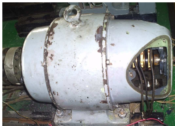
Рисунок 2 – Багатополюсна синхронна каскадна машина із суміщеними обмотками
