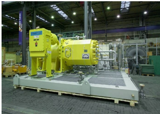
Рисунок 1 – Электроприводные газоперекачивающие агрегаты MORICO.4.HOFIM
