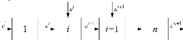
Рисунок 1 – Структура последовательно включенных установок
