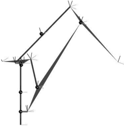
Рисунок 3 – Модель стреловой системы порталного крана в окне визуализации пакета SimMechanics
