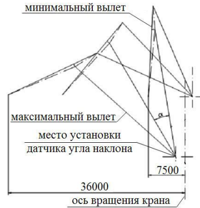
Рисунок 1 – Место установки датчика угла наклона для измерения вылета стреловой системы
