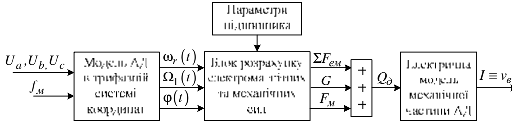
Рисунок 1 – Структурна схема моделювання вібраційних сигналів АД
