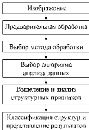
Рисунок 2 – Алгоритм обработки изображения с помощью вейвлет-преобразования
