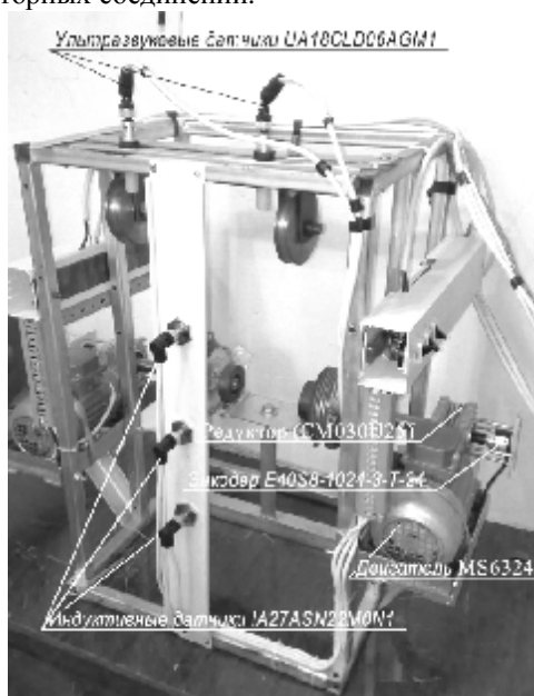
Рисунок 3 – Стенд для исследования систем позиционного и следящего привода
