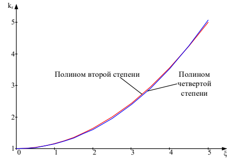
Рисунок 2 – Аппроксимация кривой изменения активного сопротивления ротора
